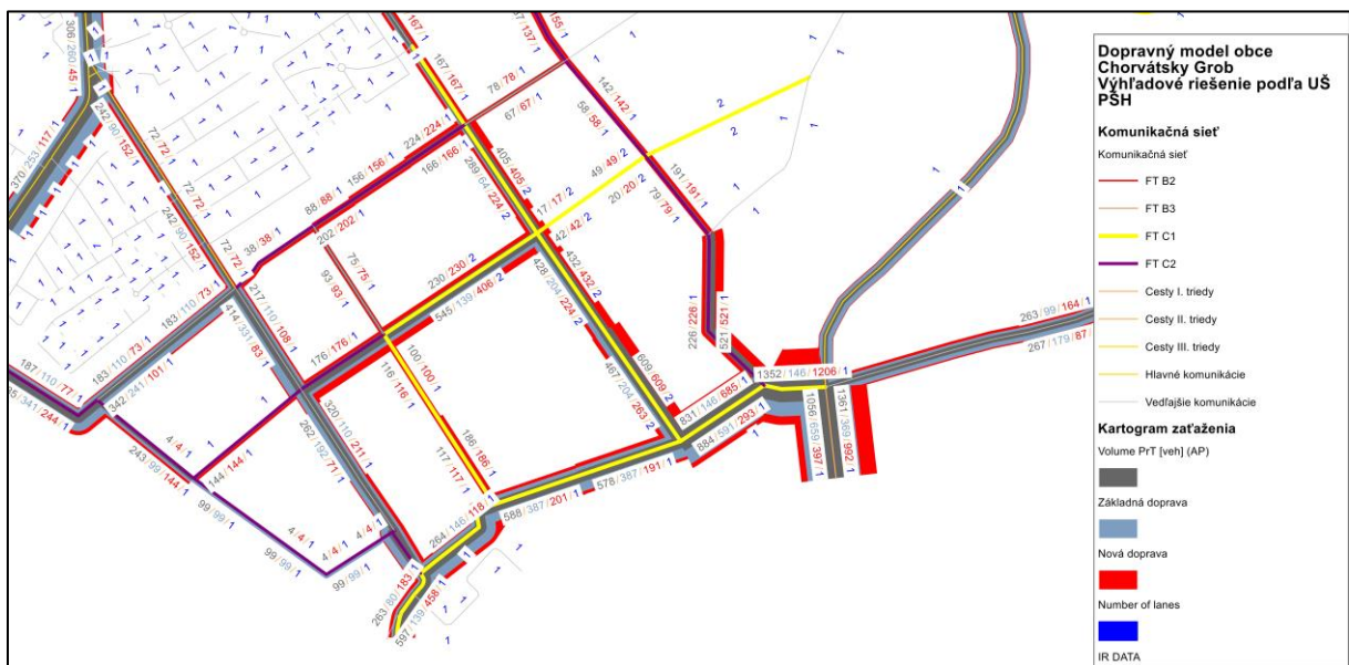
Obrázok 39 Kartogram dopravného zaťaženia cestnej siete, popoludňajšia špičková hodina (15:30 - 16:30) v riešenom území, výhľadové riešenie podľa ÚŠ obce – Etapa I+II+III_Funkčné triedy a počty jazdných pruhov ciest_1
