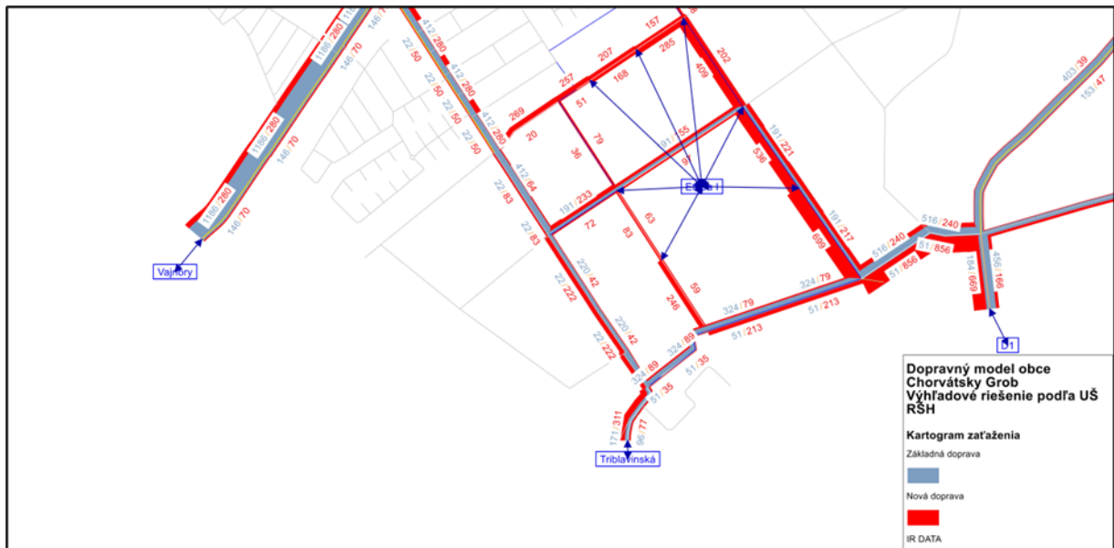
Obrázok 16 Kartogram dopravného zaťaženia cestnej siete, ranná špičková hodina (6:45 - 7:45) v riešenom území, výhľadové riešenie podľa UŠ obce – Etapa I_detail
