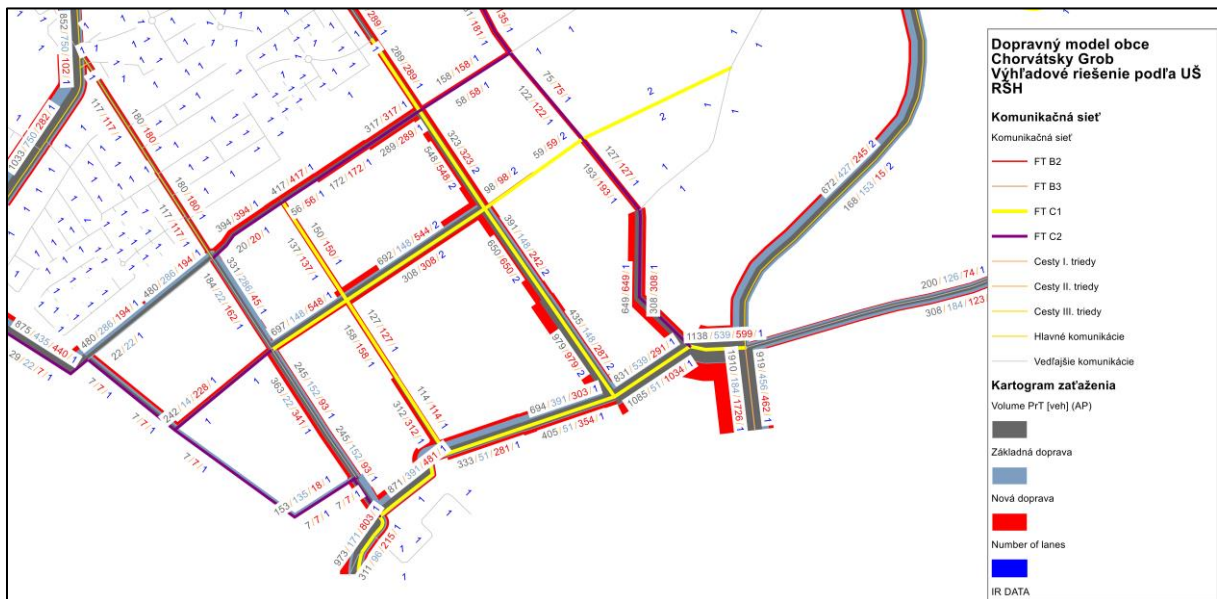
Obrázok 35 Kartogram dopravného zaťaženia cestnej siete, ranná špičková hodina (6:45 - 7:45) v riešenom území, výhľadové riešenie podľa ÚŠ obce – Etapa I+II+III_Funkčné triedy a počty jazdných pruhov ciest_1
