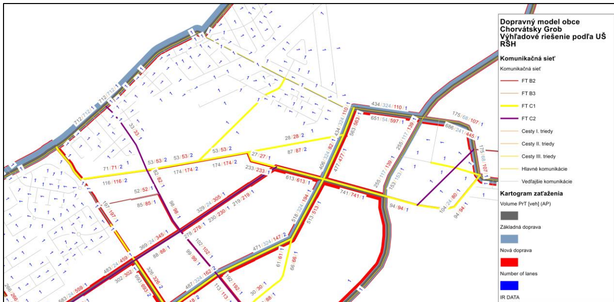
Obrázok 52 Kartogram dopravného zaťaženia cestnej siete, ranná špičková hodina (6:45 - 7:45) v riešenom území, výhľadové riešenie podľa UŠ obce – Etapa I+II+III+IV+V_Funkčné triedy a počty jazdných pruhov ciest_2
